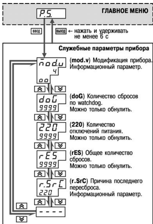
Рисунок 11.18 - Схема доступа к служебным параметрам прибора
